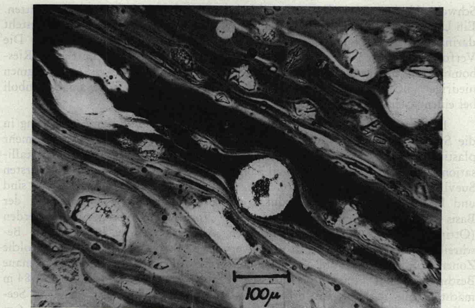
Abb. 22. Nicht rekristallisiertes Glas mit Schlieren, Blasen und Mineralfragmenten. Glasbombe aus dem Suevit von Otting.
